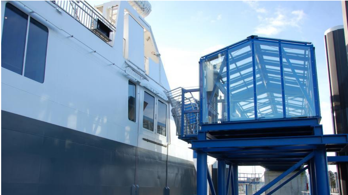
Der Übergang vom Seiteneinstieg zum Schiff wurde umgebaut
