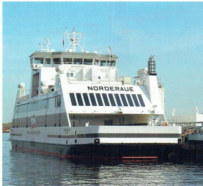
Vier Voith Schneider Propeller sorgen für den Antrieb der W.D.R.-Fähre „Norderaue“
